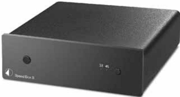
Die Project SpeedBox S ist eine kleine Spezial-Stromversorgung, die an ihrem Ausgang eine quartzgenaue 50Hz-Spannung (16V) zur Verfügung stellt. Die kompakte Bauform erlaubt es, die SpeedBox neben den Plattenspieler zu stellen. An der SpeedBox kann zudem die Geschwindigkeit von 33 auf 45upm gestellt werden: je nach Schalterstellung liefert die SpeedBox am Ausgang eine 50Hz-Spannung oder eine 67.5Hz Spannung ( $50\text{Hz} \cdot 45/33.3 = 67.5\text{Hz}$ ).
