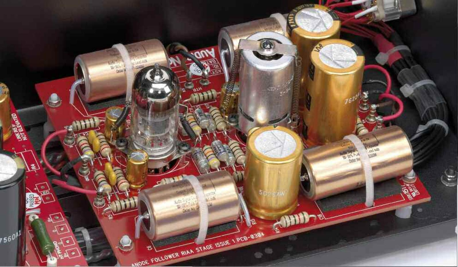
Oben: Diskret und penibel aufgebaut: Die Anodenfolger-RIAA-Entzerrung ist nicht nur klanglich ein Leckerbissen – mit entkoppelten Kondensatoren, kleinen Tantal- und Styroflex-Bypass-Kondensatoren und Nickel-Chrom-Widerständen macht auch die Schaltung einen sehr durchdachten Eindruck
