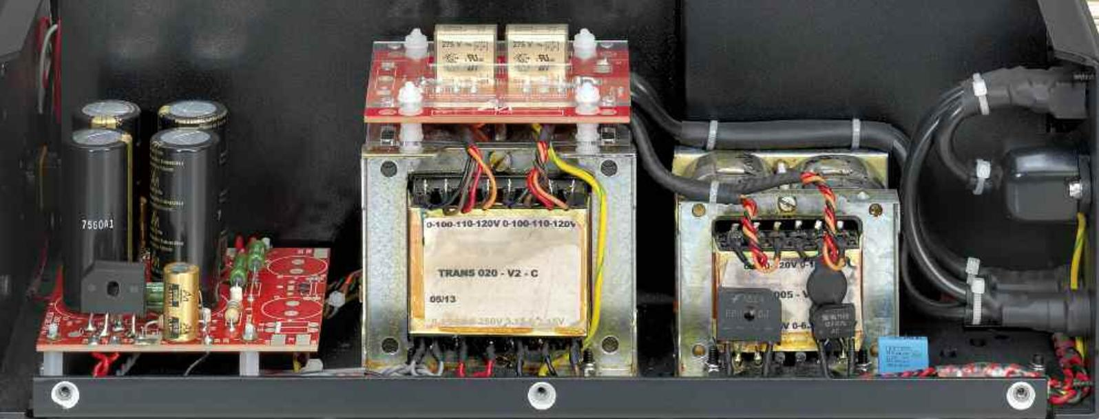
Getrennte Haupttransformatoren für die Verstärkerschaltung (links) und die Phonoentzerrung (rechts) bestimmen das geradlinige Netzteil des Oto. Teure Kaisai-Elkos gibt es nur im Silver Signature, als Gleichrichter kommen Siliziumdioden zum Einsatz
