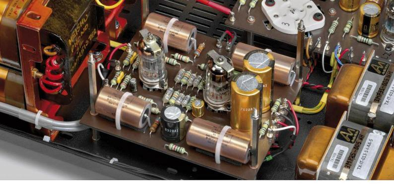
Vom Blechschirm befreit, offenbart die Phonostufe tatsächlich Röhren eines anderen Herstellers. Die Kupferfolienkondensatoren gehören dagegen wieder zum Feinsten, was Audio Note UK zu bieten hat. Zwischen den Widerständen im Signalweg finden sich "schnelle" Styroflex- und Tantal-Bypass-Kondensatoren
