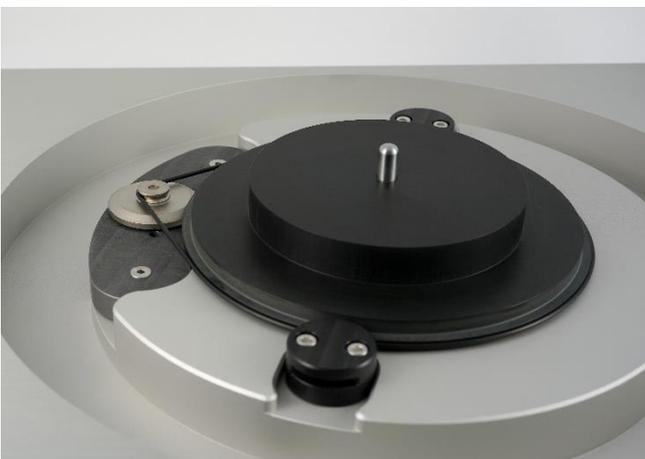
Als Hommage an den originalen EMT 928 erfolgt die Kraftübertragung mit einem Riemen. Der Hochleistungsmotor mit 20 Watt ist mit einem integrierten Regelkreis ausgestattet, der stets optimale Gangwerte sichert und gut abgeschirmt ist. Der Antrieb beschleunigt den 5,5kg schweren Plattenteller in kurzer Zeit und hält die Drehgeschwindigkeit in einem engen Toleranzfeld.
