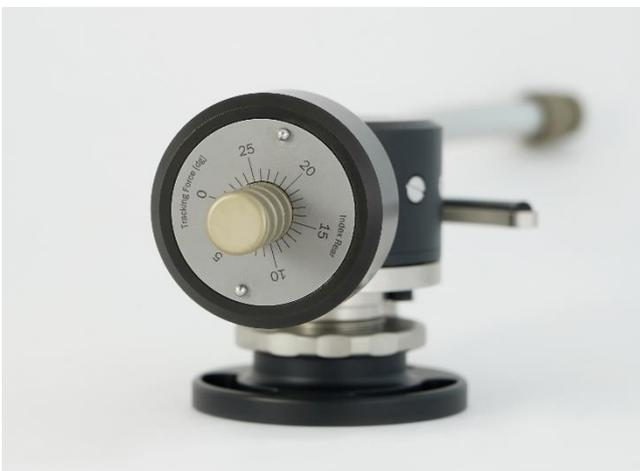
Das Gegengewicht ist über zwei PTFE-Buchsen vom Tonarmrohr entkoppelt. Ein integrierter Mechanismus mit Federvorspannung sorgt für spielfreie Positionierung über den gesamten Verstellbereich. Eine Skala kann auf Null gestellt werden, wenn sich der Tonarm im Gleichgewicht befindet. Das erlaubt die präzise Einstellung der Auflagekraft, auch wenn mal keine Tonarmwaage zur Hand ist.
