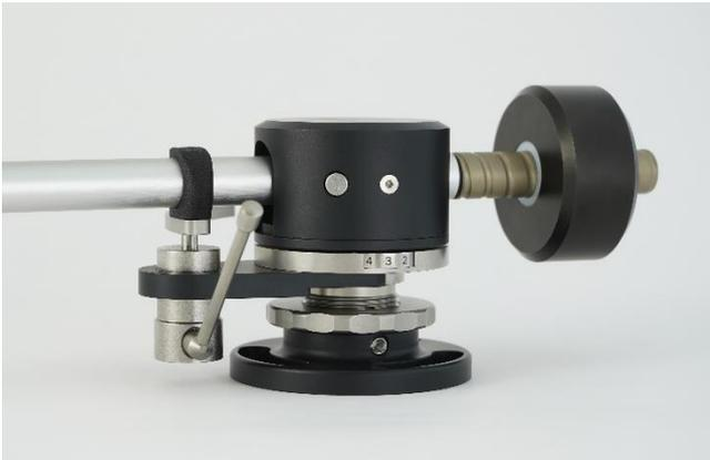
Alle Tonarm-Modelle sind mit einer magnetischen Anti-Skating-Vorrichtung und einem Gewinding für die Höhenverstellung ausgestattet. Ein Tonarmlift wird mitgeliefert und kann bei Bedarf demontiert werden. Die Abtastgeometrie ist gemäss den neusten Erkenntnissen optimiert, die Montageabstände verbleiben gemäss dem EMT-Standard.
