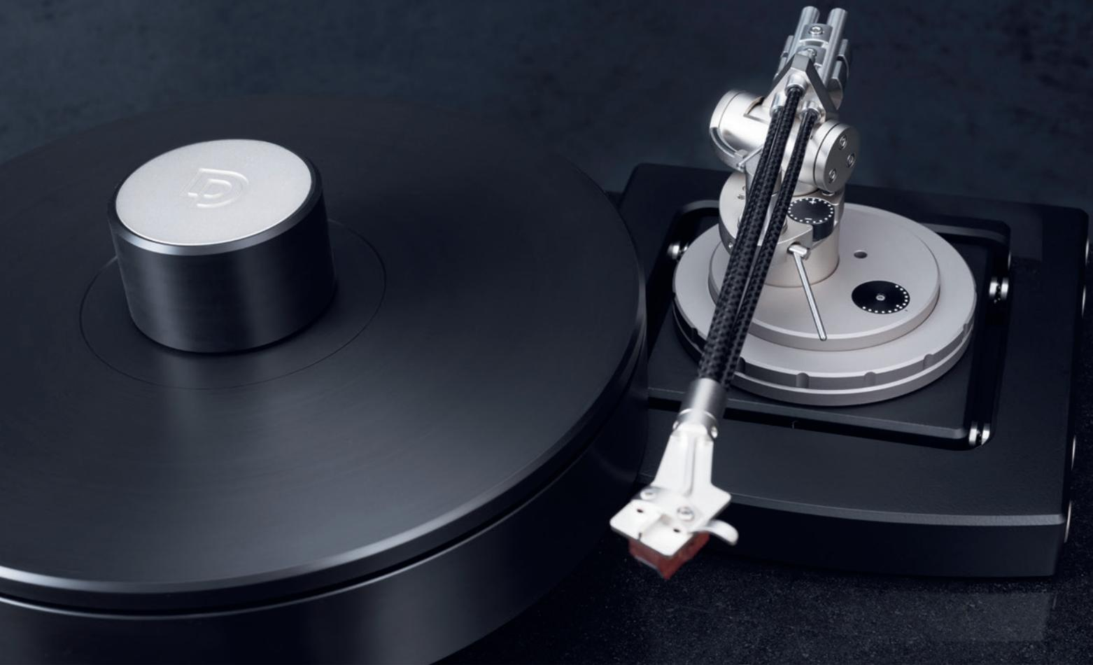
Der Tonarm wird von Magneten gehalten und ruht zwischen Präzisionskugellagern. Die drei Kohlefaser-Röhren des Tonarms sind mechanisch vorgespannt und absorbieren deshalb unerwünschte Resonanz-Schwingungen, die vom Tonabnehmer ausgehen könnten.
