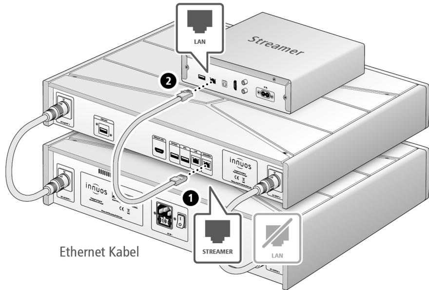
Der Streamer-Port bietet für Streamer, WLAN-Lautsprecher und andere Netzwerk-Audio-Produkte eine kabel-basierte Netzwerk-Verbindung an.
