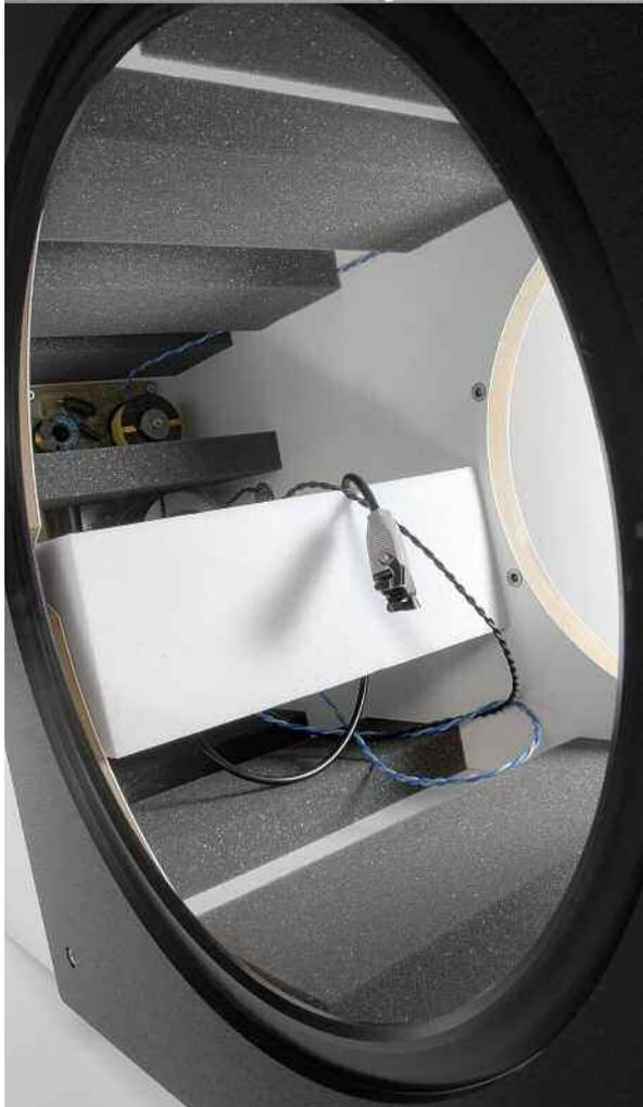
quenzen oberhalb der Resonanzfrequenz werden dagegen nur über das Tiefmitteltonchassis selbst abgestrahlt, da die Passivmembran von ihnen nicht zum Schwingen angeregt werden kann.
